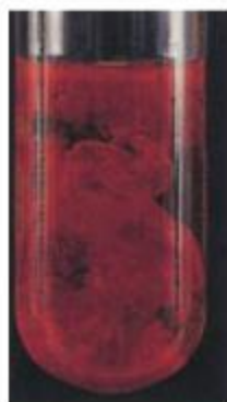
Hình 8.2. Kết tủa \text{Fe}(\text{OH})_3
