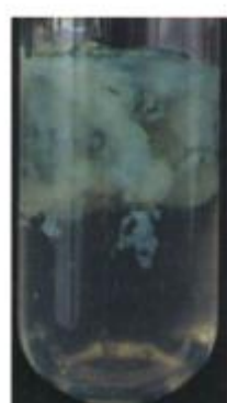
Hình 8.3. Kết tủa \text{Fe}(\text{OH})_2
