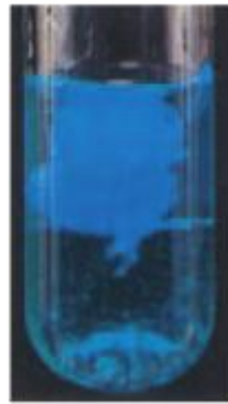
Hình 8.4. Kết tủa \text{Cu}(\text{OH})_2
