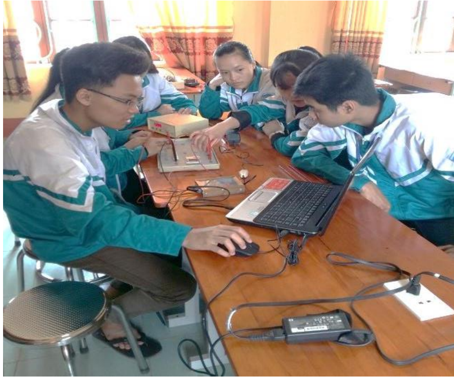
Ảnh 3. HS sử dụng phần mềm Scope để chứng minh độ lệch pha giữa hiệu điện thế và cường độ dòng điện
