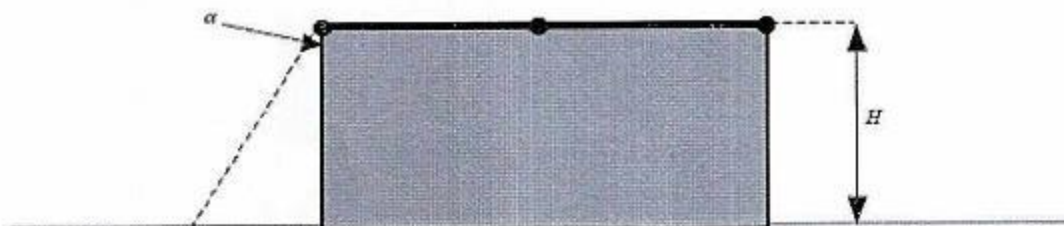
Hình B.4 - Vùng được bảo vệ bởi các dây dẫn dạng lưới tách biệt, xác định theo phương pháp góc bảo vệ và phương pháp quả cầu lăn
