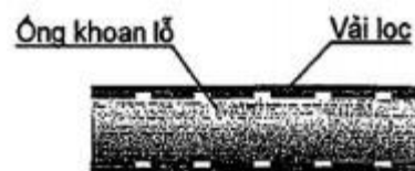
Hình 5 - Chi tiết ống thoát nước, khí
