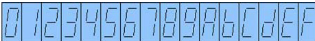
Hình 4.1: Dạng chữ và số hiển thị được trên Led 7 thanh
