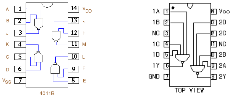
Hình 2.9: IC 4011 và IC 74HC20
