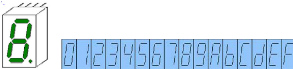
Hình 3.1: Led 7 thanh và dạng ký tự hiển thị
