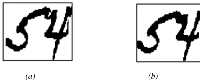
Hình 1.5. (a) Ảnh gốc, (b) Ảnh sau khi được làm trơn biên.
