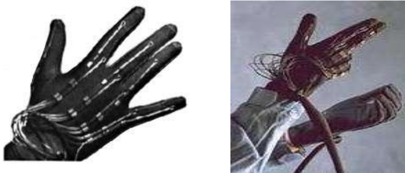
Hình 1. 19. Thiết bị Data glove trong hệ thống VR nhúng toàn phần
