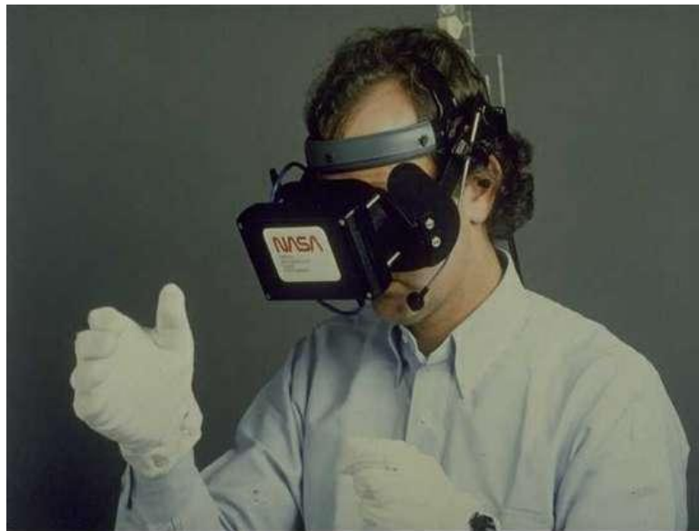
Hình 1. 5. Thiết bị HMD-1984 của NASA
