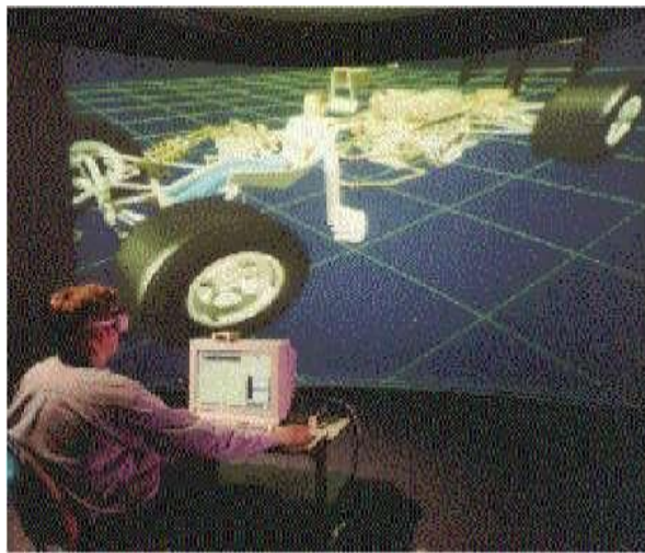
Hình 1. 18. Hệ thống chiếu màn ảnh rộng kết hợp kính ShutterGlasses trong hệ thống VR Bán nhúng
