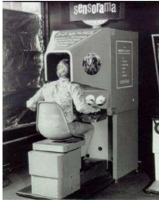
Hình 1. 2. Thiết bị mô phỏng Sensorrama - 1960
