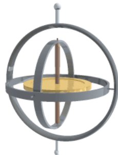
Hình 5: Mô tả hoạt động của một con quay hồi chuyển
