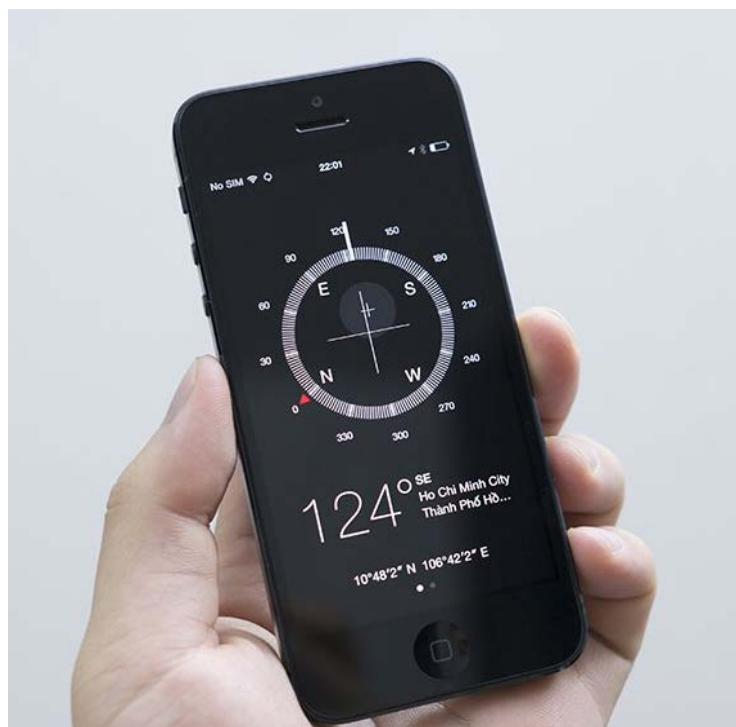
Hình 7: Cảm biến từ kế xác định chính xác hướng của điện thoại thông minh
