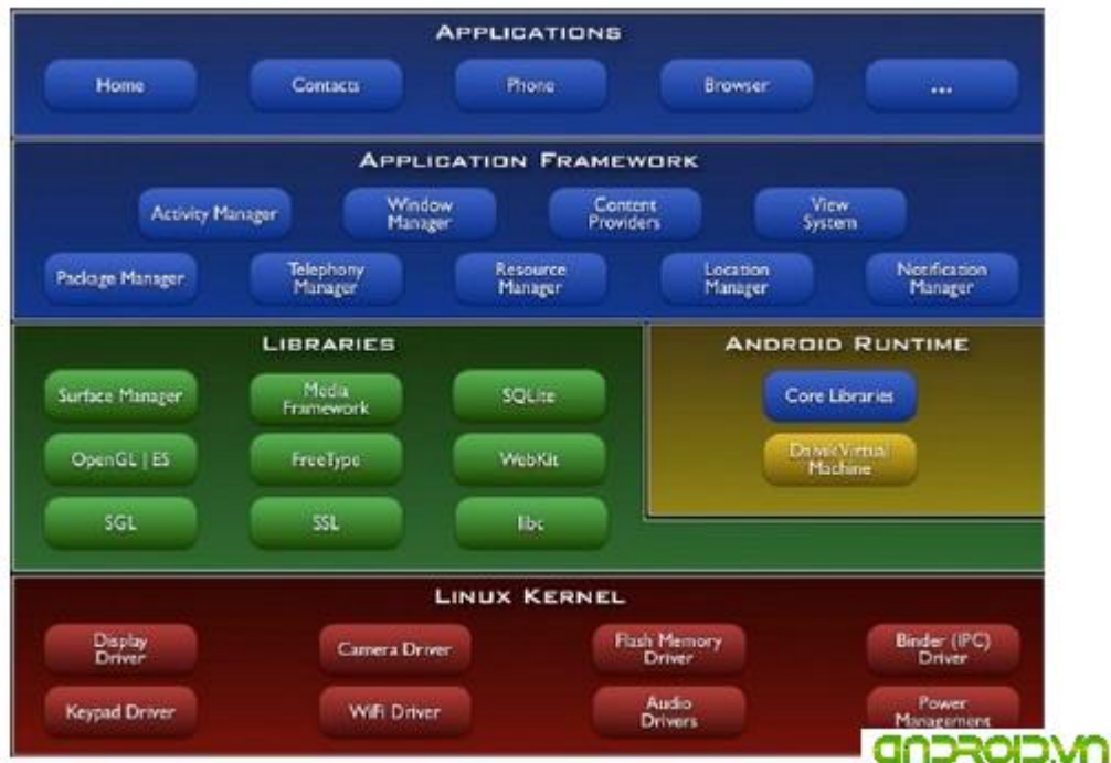
Hình 3.2: Sơ đồ về kiến trúc của Android
