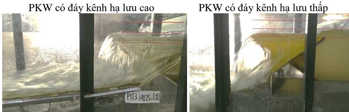
Hình 3.18 Dòng chảy ở hạ lưu tràn piano khi H_0/P_H=0,2
