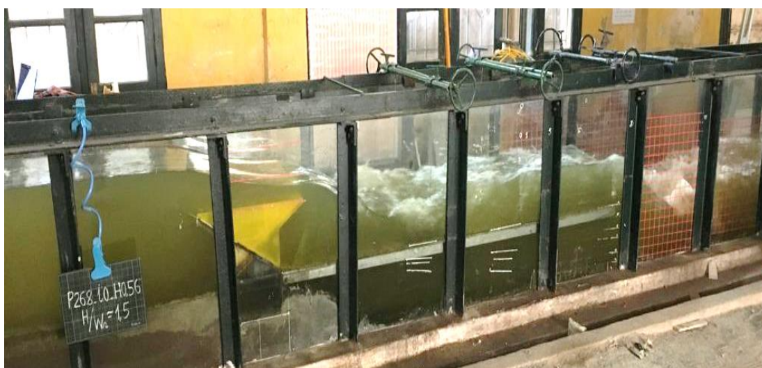
Hình 3.16 Tràn piano có kênh hạ lưu cao ngang chân phím nước ra
