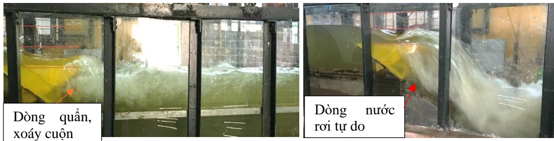
Hình 3.19 Dòng chảy ở hạ lưu tràn khi H_0/P_H=0,7
