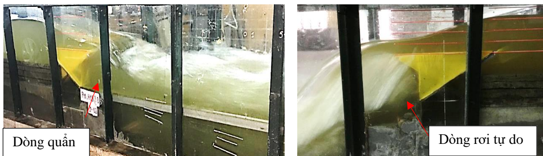
Hình 3.20 Dòng chảy ở hạ lưu tràn khi H_0/P_H=1,0
