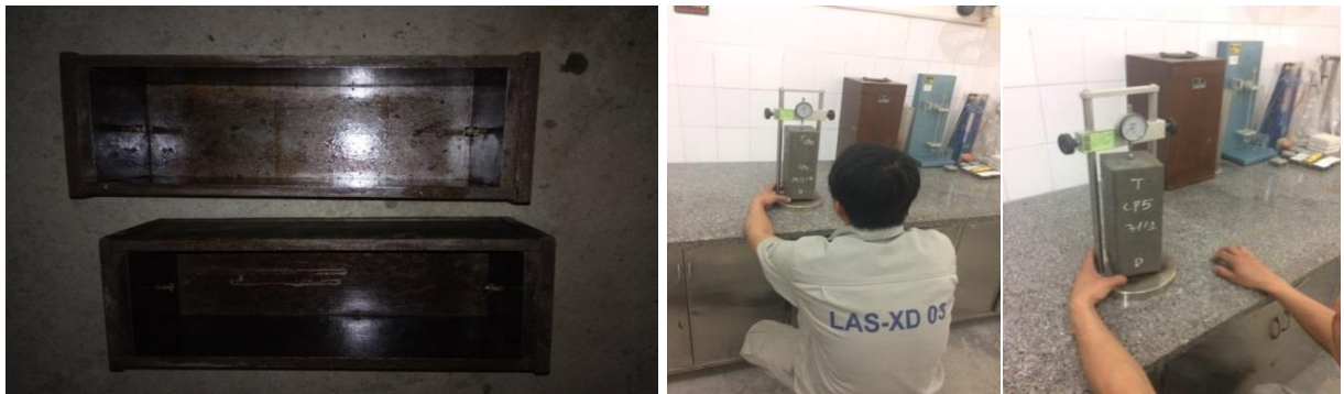
Hình 2.3. Thí nghiệm đo độ co khô của bê tông
