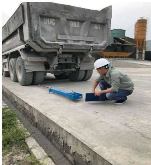
Hình 5.4. Kiểm tra độ bằng phẳng, độ nhám và mô đun đàn hồi mặt đường bê tông xi măng và sân bãi của Nhà máy 1 và Nhà máy 2
