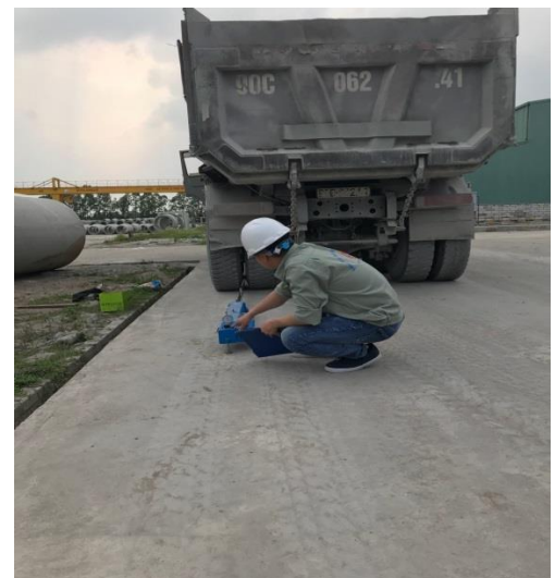
Hình 5.4. Kiểm tra độ bằng phẳng, độ nhám và mô đun đàn hồi mặt đường bê tông xi măng và sân bãi của Nhà máy 1 và Nhà máy 2
