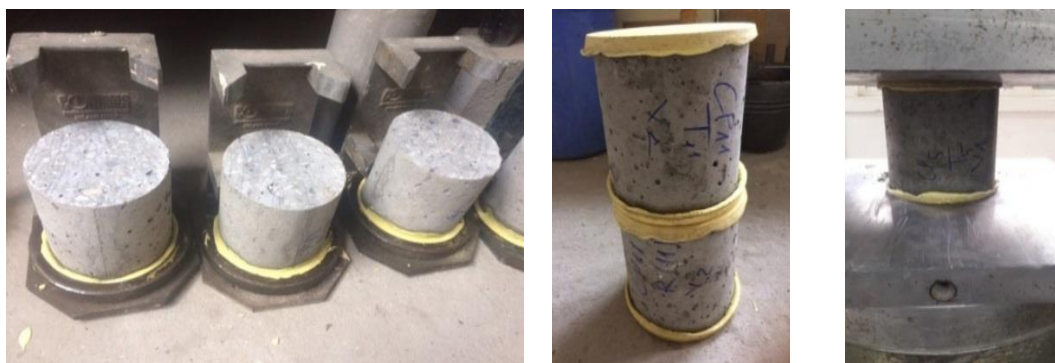
Hình 3.22. Thí nghiệm cường độ chịu nén của bê tông
