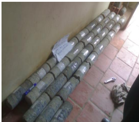
Hình 5.3. Khoan mẫu bê tông công trình đường giao thông, sân bãi của Nhà máy 1 và Nhà máy 2 để kiểm tra các chỉ tiêu cơ lý, chiều dày kết cấu bê tông
