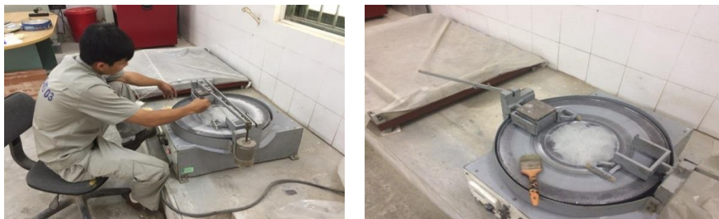
Hình 3.23. Thí nghiệm độ mài mòn của bê tông
