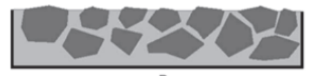
Hình 1.7. Sự phá hoại mẫu bê tông khi bị mài mòn A – mẫu bê tông ; B - bê tông bị mài mòn
