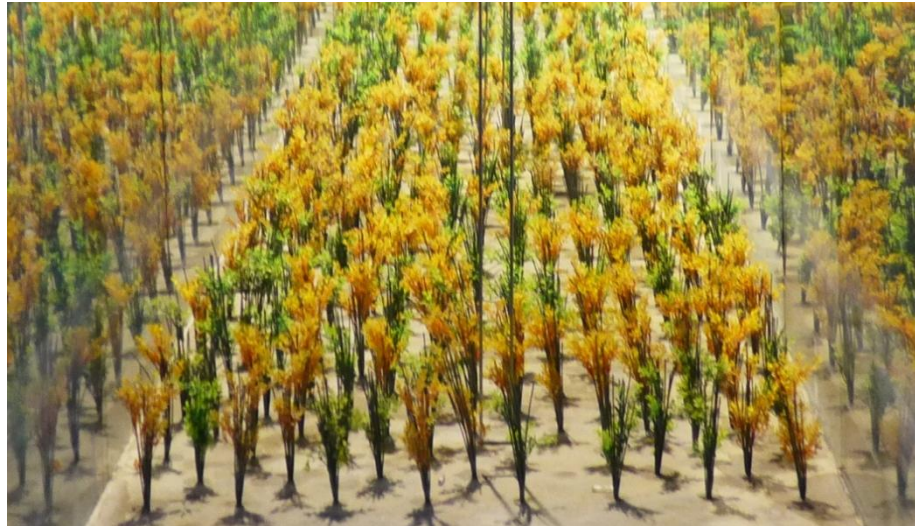
Hình 2.10. Mô hình hóa và bố trí CNM trên máng sóng (Cây nhựa)
