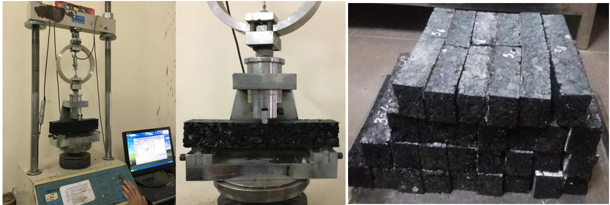
a/ Thí nghiệm kéo uốn trên máy Marshall
