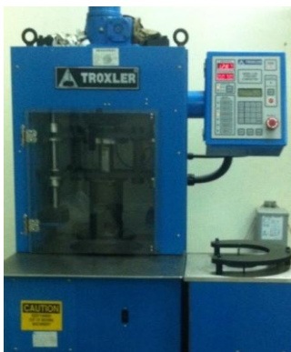
Hình 3-34. Chuẩn bị mẫu thí nghiệm bằng đầm xoay Troxler
