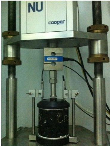
Hình 3-35. Thí nghiệm mô đun động trên thiết bị Cooper
