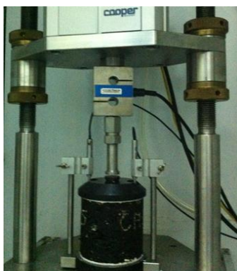
Hình 3-8. Thiết bị Cooper và mẫu BTN trong thí nghiệm mô đun đàn hồi tĩnh
