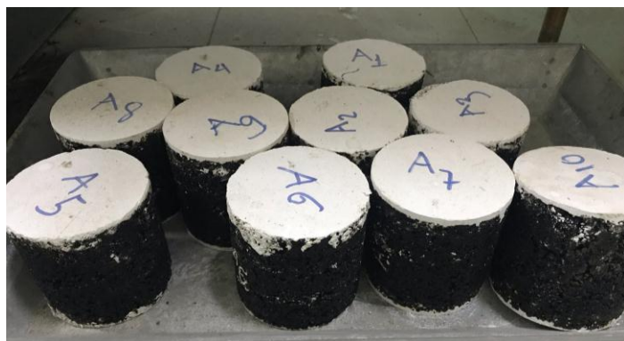
Hình 3-34. Chuẩn bị mẫu thí nghiệm bằng đầm xoay Troxler
