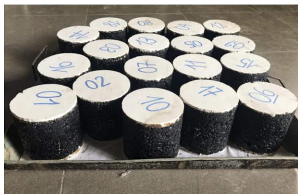
Hình 3-8. Thiết bị Cooper và mẫu BTN trong thí nghiệm mô đun đàn hồi tĩnh
