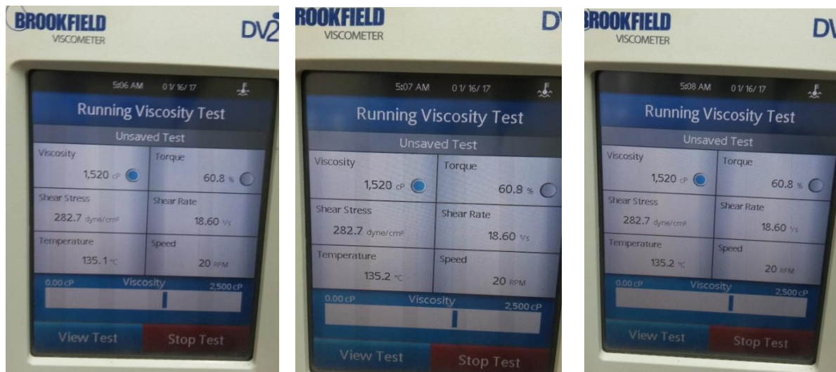
Hình 2-11. Kết quả thí nghiệm độ nhớt ở 135 0 C (nhớt kế Brookfield) của BE35
