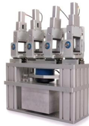
Hình 3-20. Thiết bị mỏi 4 điểm Cooper CRT-SA4PT-BB [16]
