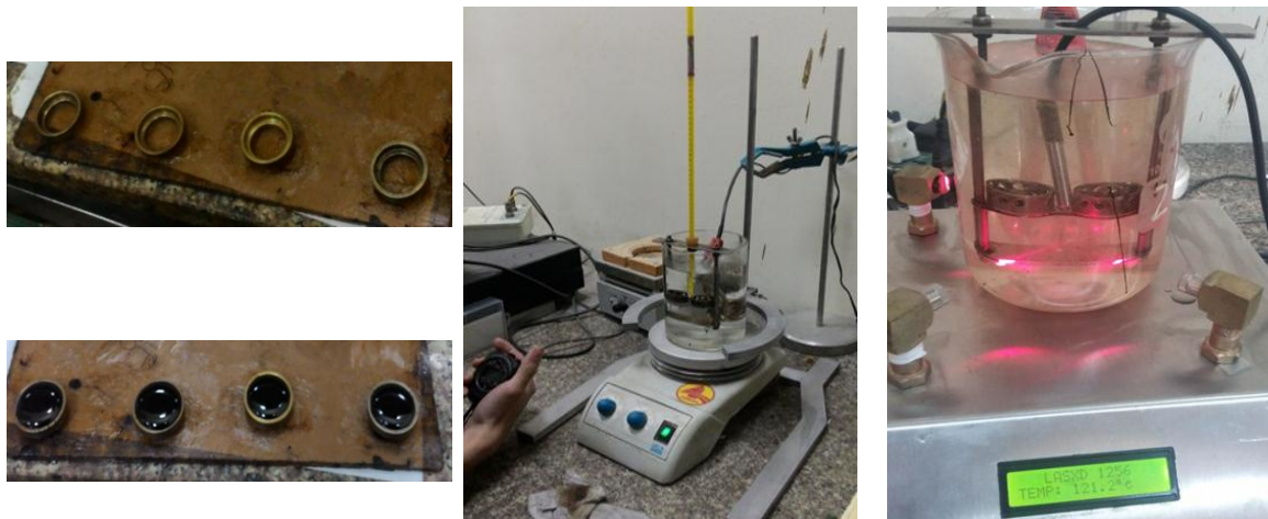
Hình 2-7. Một vài hình ảnh thí nghiệm xác định nhiệt độ hóa mềm
