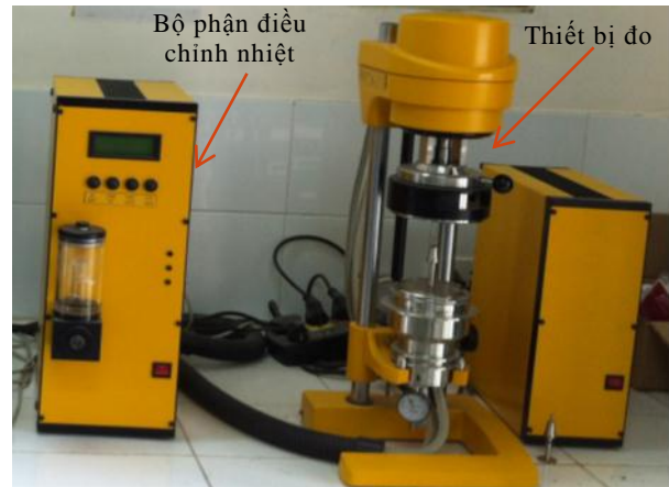
Hình 2-14. Thiết bị cắt động lưu biến DSR RHEOTEST RN 4.3 tại Trường ĐH GTVT
