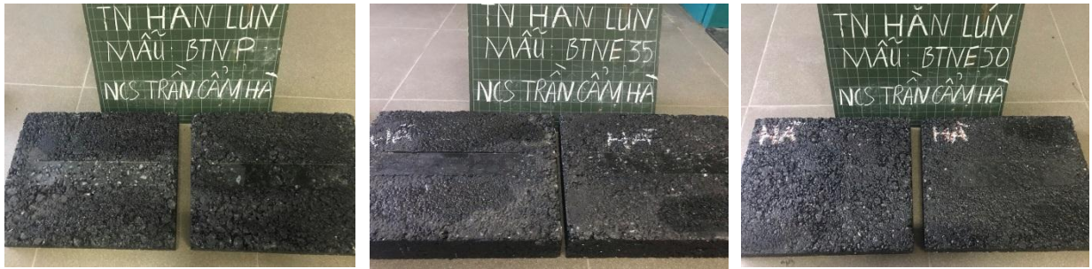
Hình 3-19. Hình ảnh các mẫu BTN sau thí nghiệm xác định khả năng kháng lún
