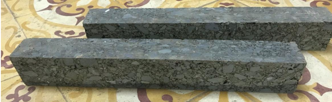
Hình 3-21. Mẫu thí nghiệm 380\text{mm} \times 50\text{mm} \times 50\text{mm}
