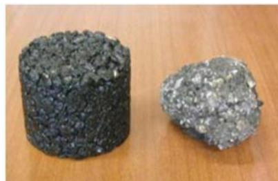
Hình 1-15: Hình ảnh mẫu OGPA trước và sau thí nghiệm Cantabro [21]
