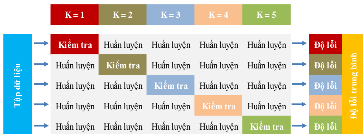
Hình 2: Mô tả phương pháp thử nghiệm K-Fold với k=5
