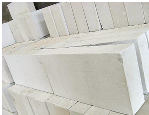
Hình 1.6: Gạch bê tông khí chưng áp (AAC)
