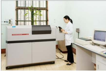
Máy kiểm tra thành phần quang phổ ARL 3460 (Thụy Sĩ)
