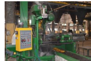
Máy làm thao Shell core
