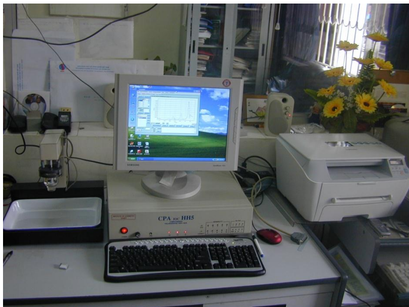
Hình 2.1: Hệ thống thiết bị phân tích điện hoá đa năng CPA-HH5
