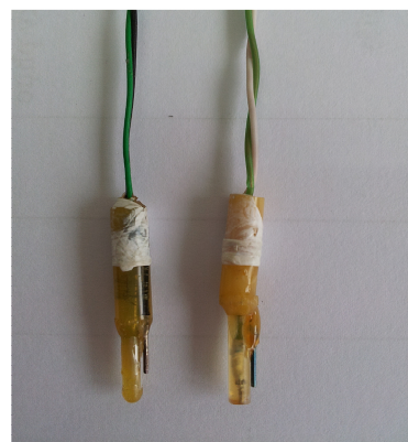
Hình 2.16 Điện cực ViAu sau khi chế tạo.
