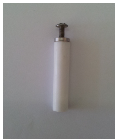
Hình 2.2 Sơ đồ cấu tạo điện cực GC. Hình 2.3 Điện cực GC sau khi chế tạo.
