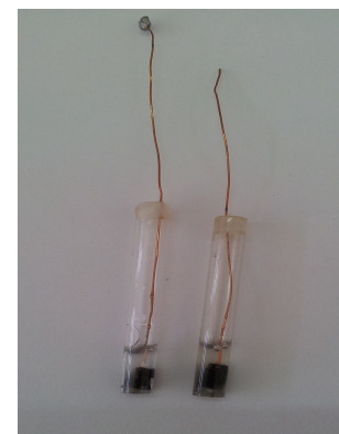
Hình 2.14 Điện cực ViC2 sau khi chế tạo.
