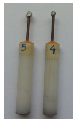
Hình 2.9 Điện cực CpTOMA sau khi chế tạo.
