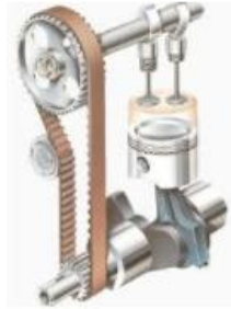
Hình 2.4. Đai truyền răng dẫn động trục cam
