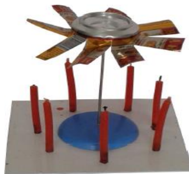
Hình 3.21: Ảnh chụp bố trí thí nghiệm đối lưu nhiệt phụ thuộc vào độ chênh lệch của nhiệt độ
