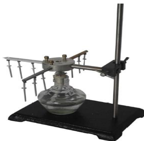
Hình 3.20: Ảnh chụp bố trí thí nghiệm dẫn nhiệt của 3 vật (đồng, sắt và thủy tinh)
