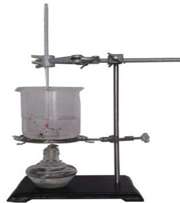
Hình 3.16: Ảnh chụp bố trí thí nghiệm đo nhiệt độ của nước
