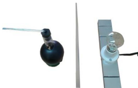
Hình 3.19: Ảnh chụp bố trí thí nghiệm hiện tượng bức xạ nhiệt
