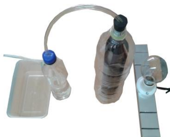
Hình 3.22: Ảnh chụp bố trí thí nghiệm sự hấp thụ nhiệt phụ thuộc vào màu sắc
